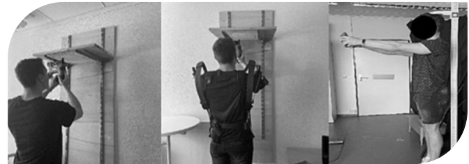
Figuur 2a. (van links naar rechts) Gebruik van het nagelpistool zonder exoskelet. Gebruik van het nagelpistool met exoskelet, vermoeidheidsprotocol.
