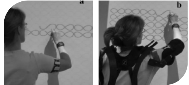
Figuur 1a. Een deelnemer die de preciezetaak P uitvoert zonder exoskelet (a) en met het exoskelet (b).
