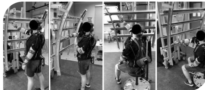
Figuur 3a. Horizontale afdichtingstaken en starthoudingen (van links naar rechts) a) staand afdichten langs de bovenste stringer b) staand afdichten langs de onderste stringer c) zittend afdichten langs de bovenste stringer d) zittend afdichten langs de onderste stringer.
