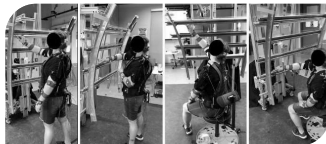
Fig. 3a. Tâches d'étanchéité horizontales et postures de départ (de gauche à droite) a) étanchéité debout le long du raidisseur supérieur b) étanchéité debout le long du raidisseur inférieur c) étanchéité assise le long du raidisseur supérieur d) étanchéité assise le long du raidisseur inférieur.
