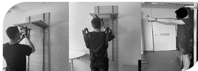
Fig. 2a. (de gauche à droite) Utilisation du pistolet à clous sans exosquelette. Utilisation du pistolet à clous avec exosquelette, protocole de fatigue.
