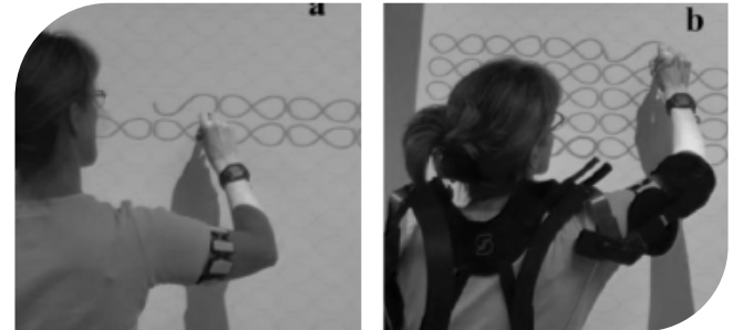
Abb. 1a. Eine Versuchsperson die die Präzisionsaufgabe P ohne Exoskelett (a) und mit Exoskelett (b) ausführt.
