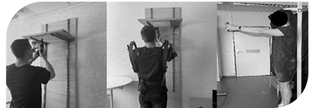
Abb. 2a. (von links nach rechts) Verwendung der Nagelpistole ohne Exoskelett. Verwendung der Nagelpistole mit Exoskelett, Ermüdungsprotokoll.
