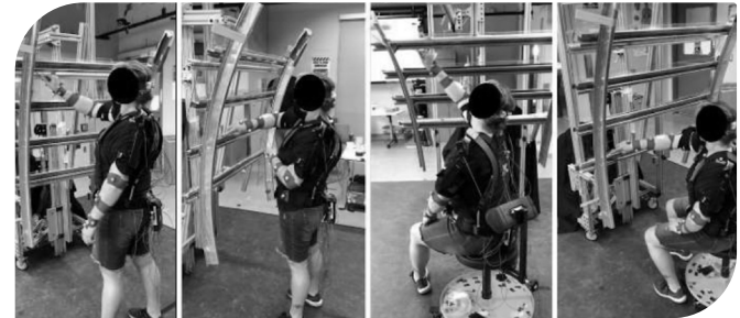
Abb. 3a. Horizontale Abdichtungsarbeiten und Ausgangshaltungen (von links nach rechts) a) stehende Abdichtung entlang des oberen Stringers b) stehende Abdichtung entlang des unteren Stringers c) sitzende Abdichtung entlang des oberen Stringers d) sitzende Abdichtung entlang des unteren Stringers.
